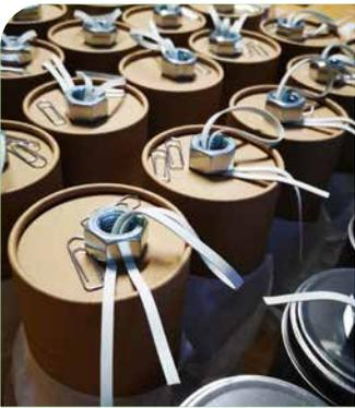
Eine Dose wird in eine Richtung geschubst und kehrt wie von Geisterhand auf halbem Wege zurück? Mit einfachsten Mitteln erklärt das Experiment den Boomerang-Effekt und die Wirkung kinetischer Energie.
